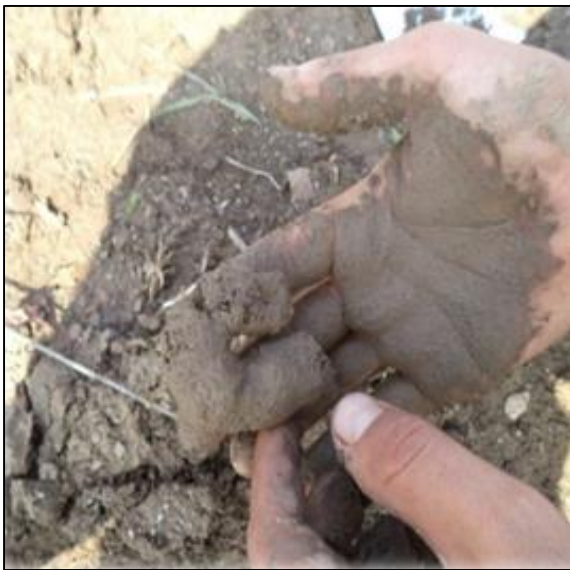
Figure 6 : Test de Boudin (ARRAR et HAMANINE, 2015)
