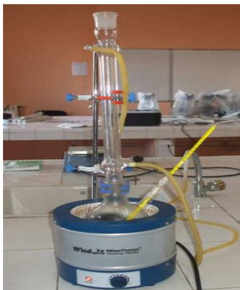
**Figure 9 :** Montage de l'activation chimique du charbon
