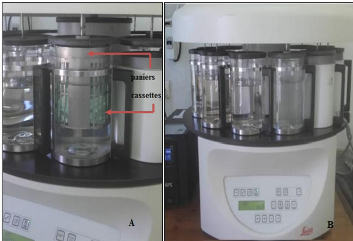
**Figure 17 :** préparation les cassettes dans le panier (A), Automate de déshydratation (leica) (B) (photographie originale).
