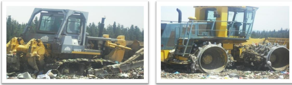
**Figure n ° 07 : Poussée et Compactage [24].**
