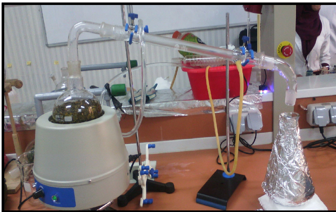
Figure 10 : montage utilisé pour l'hydrodistillation
