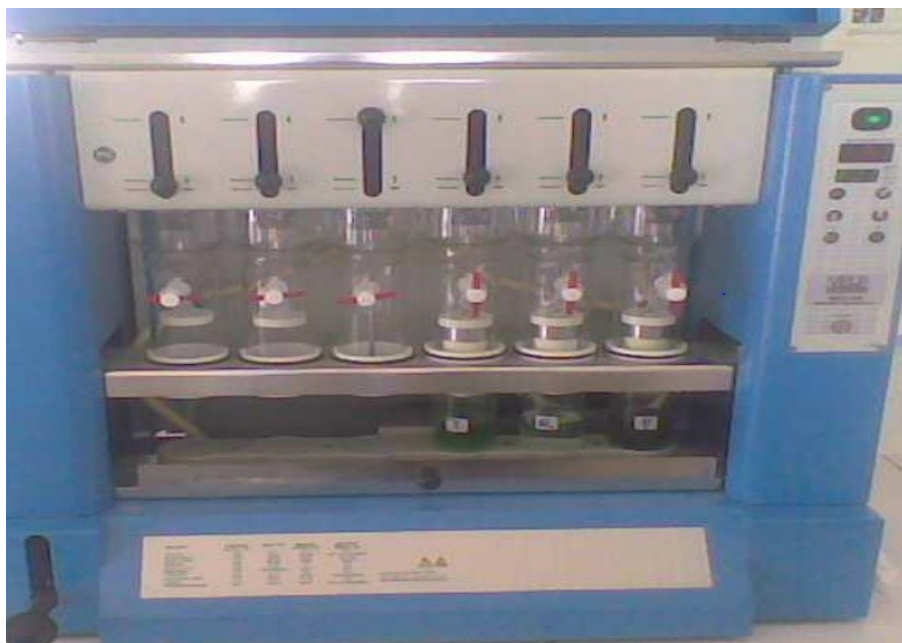
Figure 06 : Montage de l'appareil de soxhlet.
