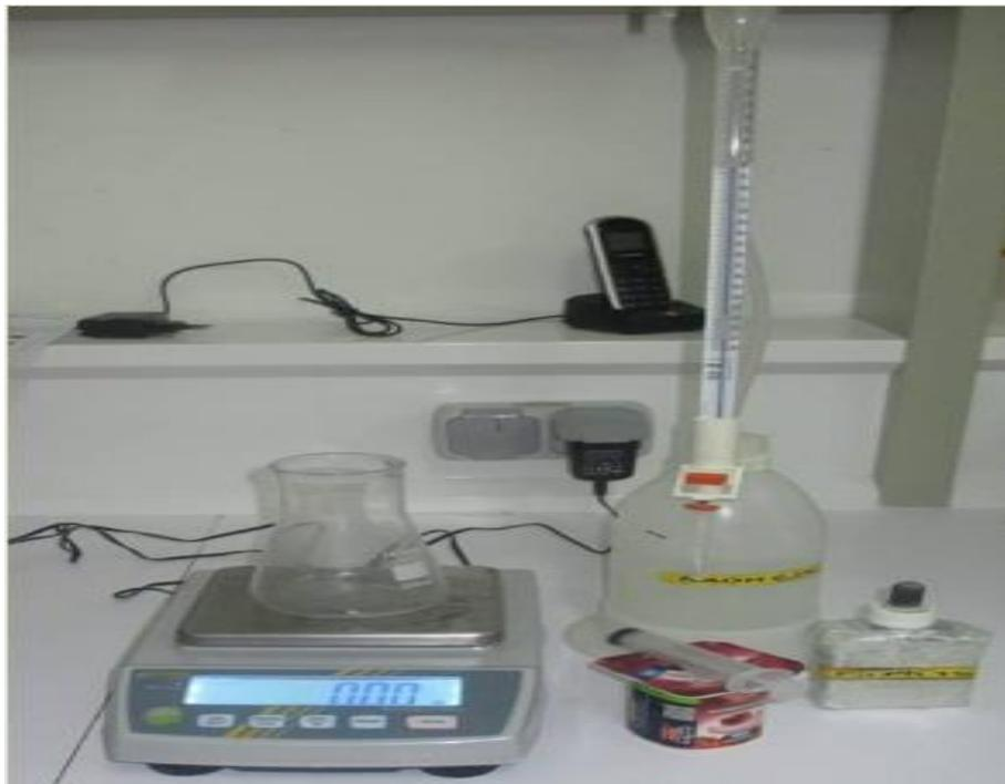
**Figure 09:** Photographie représente les matériels utilisés lors de la détermination de l'acidité du yaourt (Originale).
