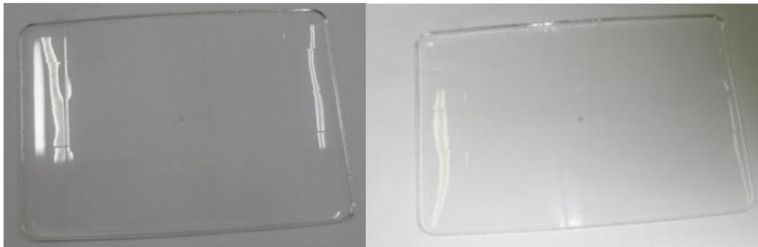
**Figure : 2.10 :** *Photographies des échantillons EP pur*
