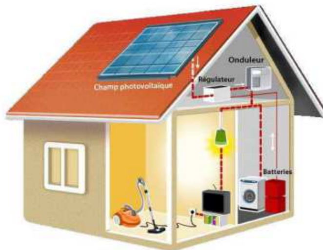
Figure .II.1 : Système photovoltaïque autonome [Xua 15].
