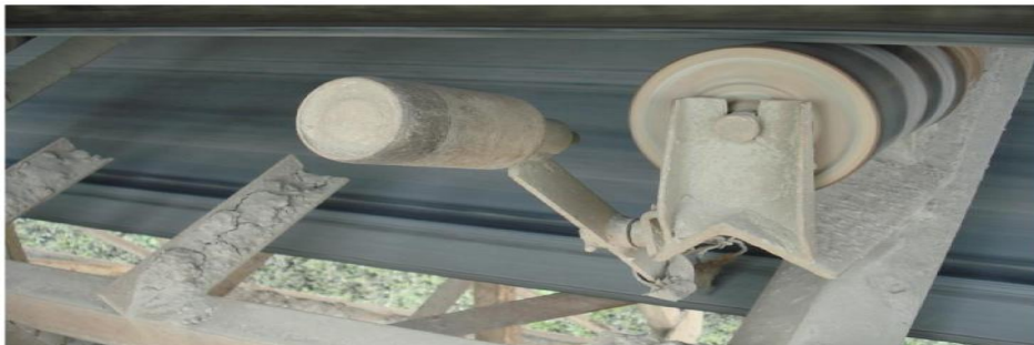
Figure II.26: capteur TOR a débordement de bande.
