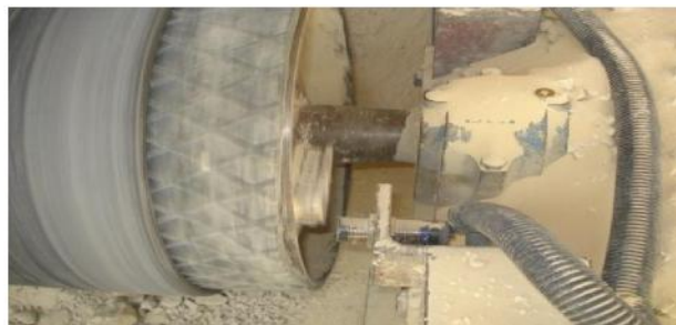
Figure II.27: capteur TOR un contrôleur de rotation.
