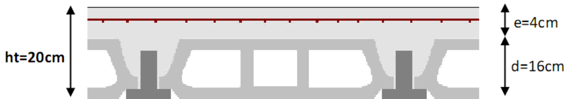
Fig II.4 Dimensionnement de plancher corps creux.
