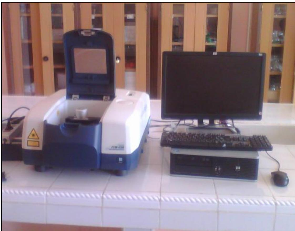
**Figure II. 7:** photo du spectromètre IR à transformée de Fourier (IRTF) de types FT/IR-420 JASCO.
