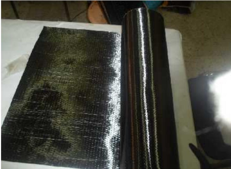
**Figure 34.** Fibre de carbone Le SikaWrap®-230 C/45
