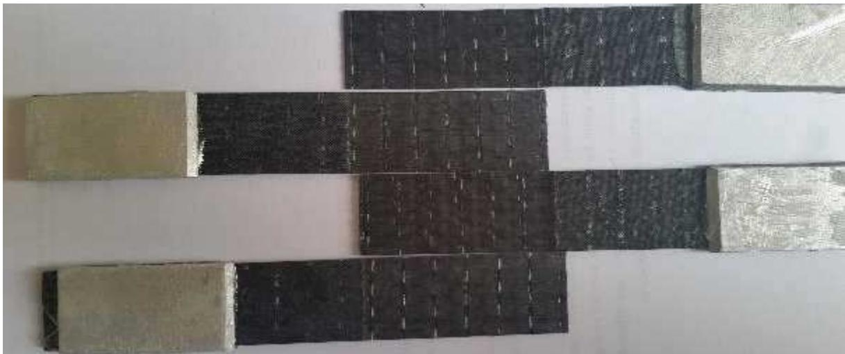
**Figure 58.** Eprouvette d'adhérence 4/4 après traction.
