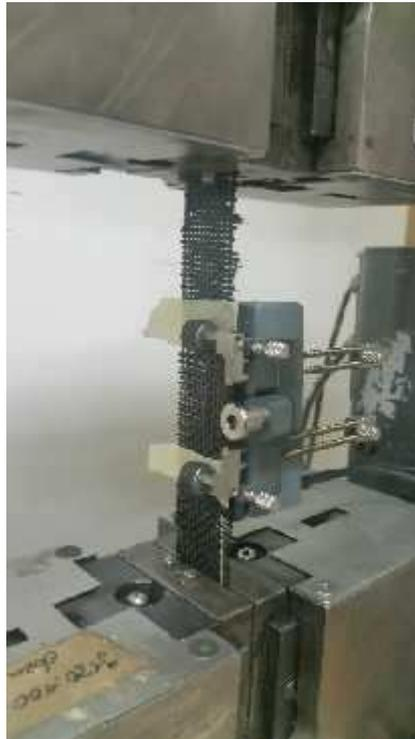
**Figure 37.** Banc d'essai de traction sur tissu de carbone
