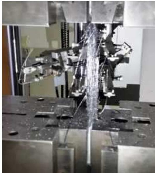
Figure 47. Rupture d'éprouvette après traction
