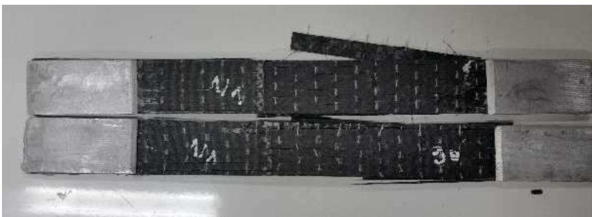
Figure 53. Eprouvette d'adhérence 1/1 après traction.
