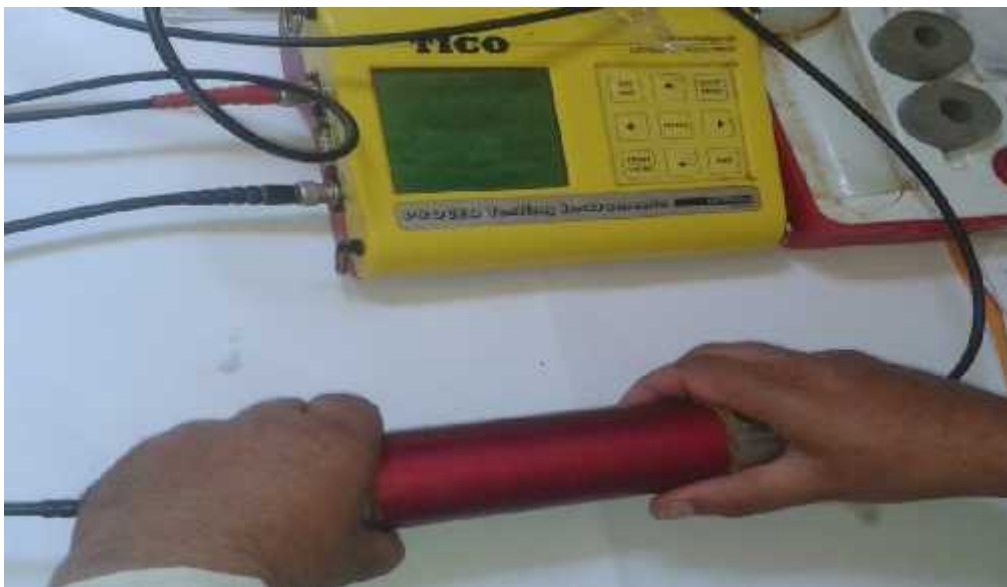
Figure 55: étalonnage de l'appareil ultrason(TICO).
