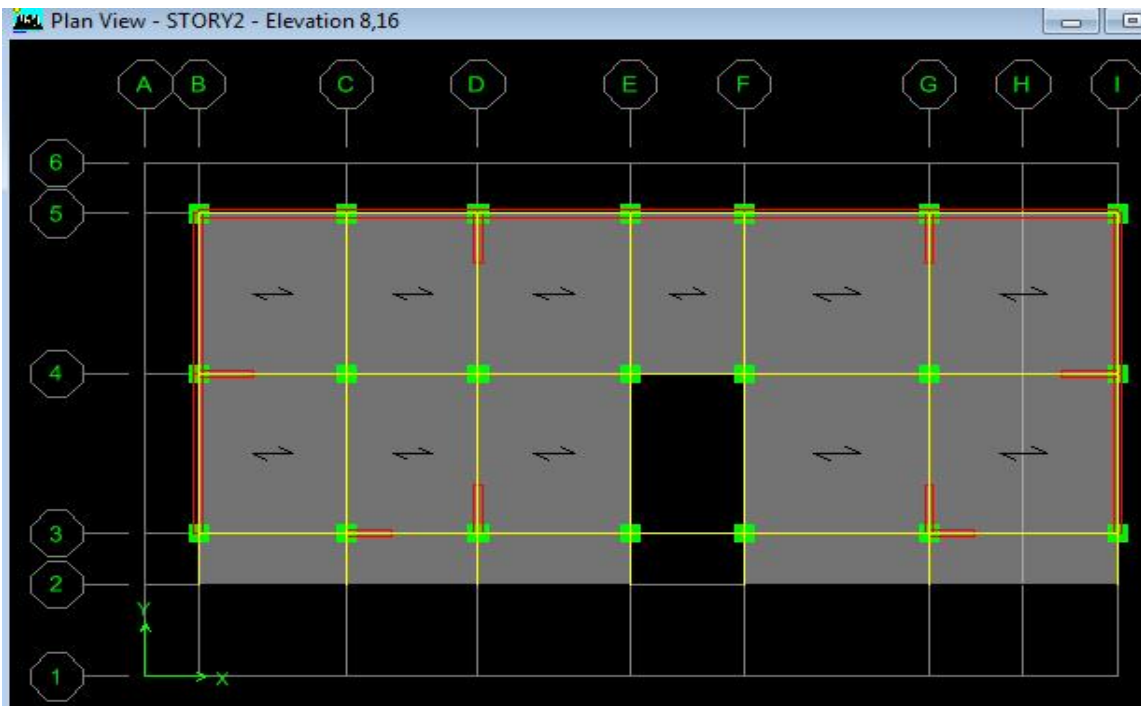
Figure IV-3 : La disposition des voiles pour entre sol (2).
