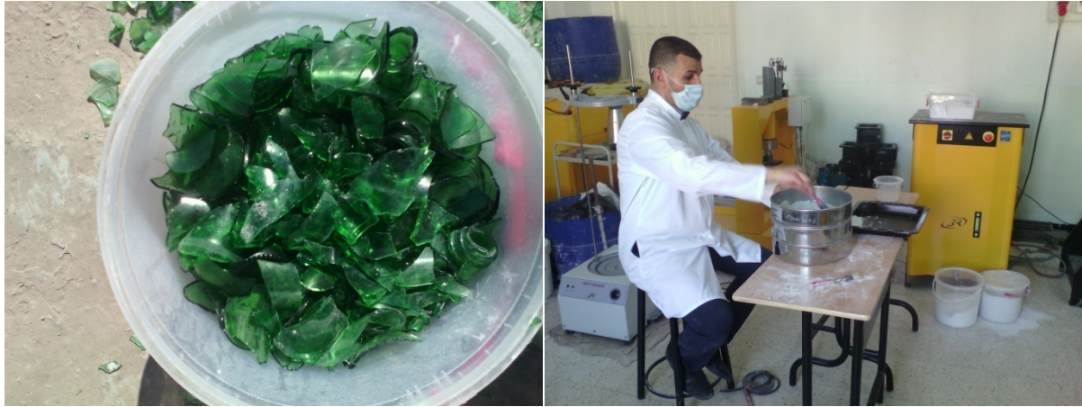
Figure III 1: Préparation de la poudre de verre.
