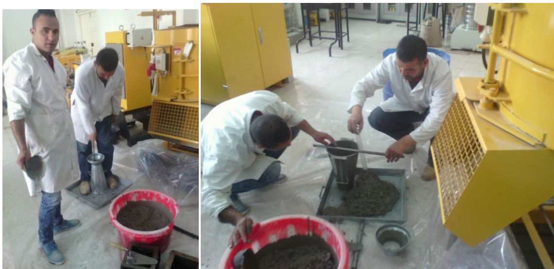
Figure III 4: Photos des essais d'affaissement au cône d'Abrams
