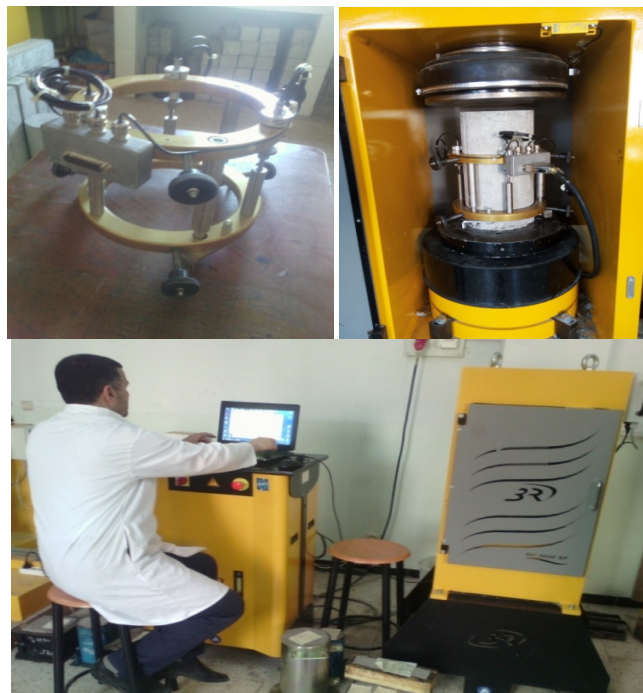
Figure III 6: Préparation de l'essai de mesure de module d'élasticité statique
