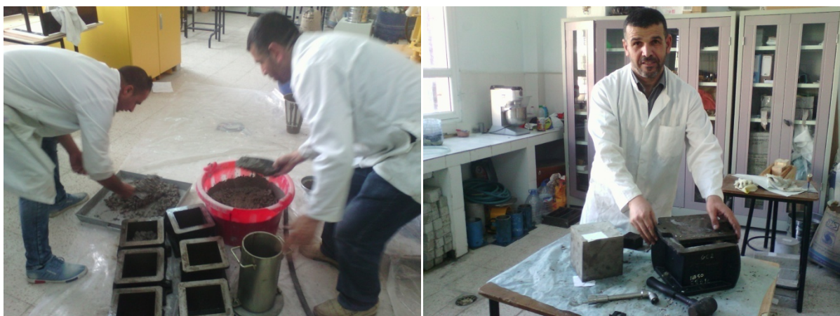
Figure III 5 : Confection et démoules des éprouvettes et essais de compression
