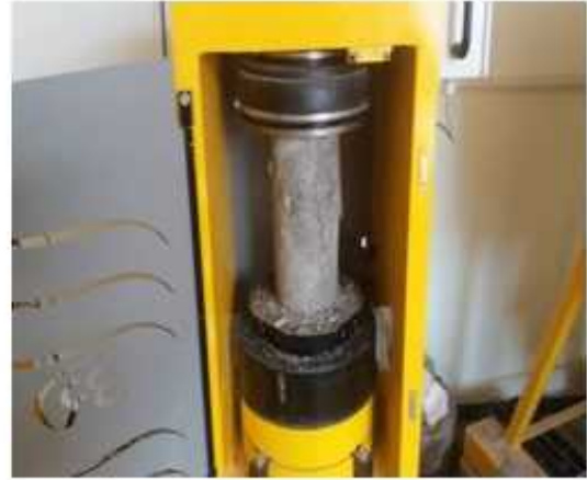
Éprouvette après écrasement
