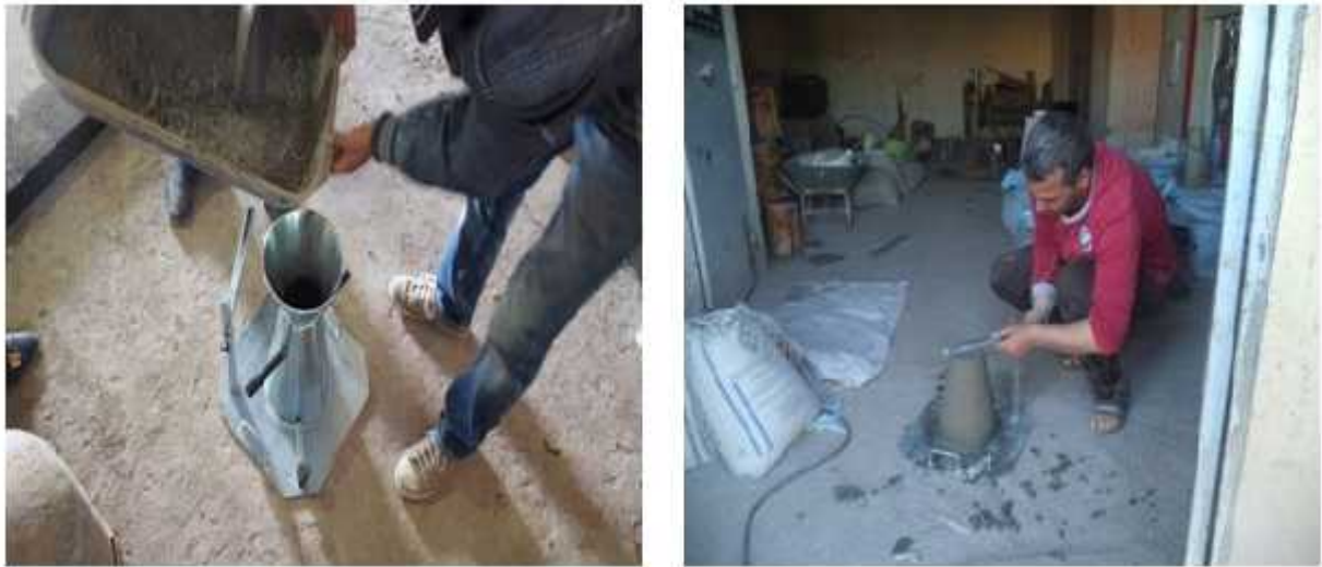
Figure II.6. Affaissement au cône d'Abrahams
