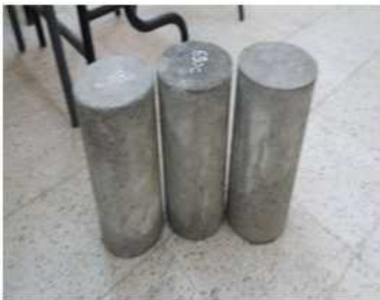
Éprouvettes cylindrique 16x32 cm
