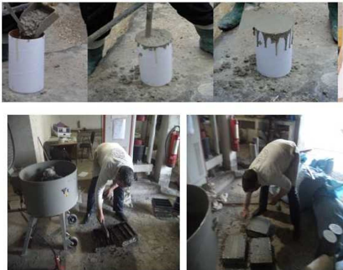
Figure II.5 - Confection des éprouvettes (cylindriques et prismatiques)
