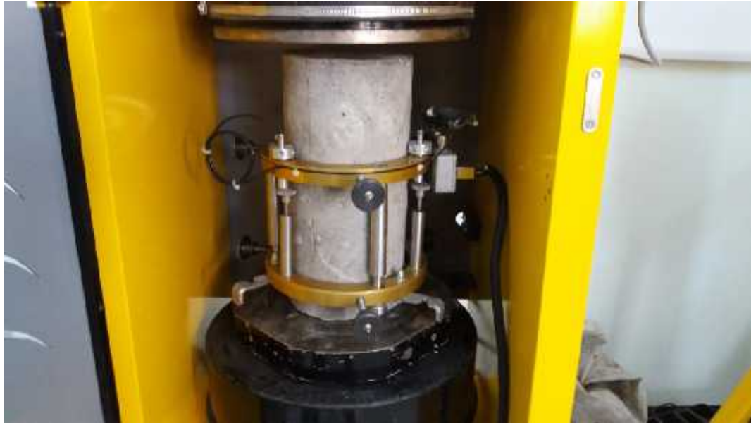
Figure II.10 Essai de compression avec enregistrement des déplacements (Extensomètre)
