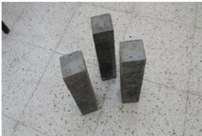
Éprouvettes prismatiques 7x7x28 cm
