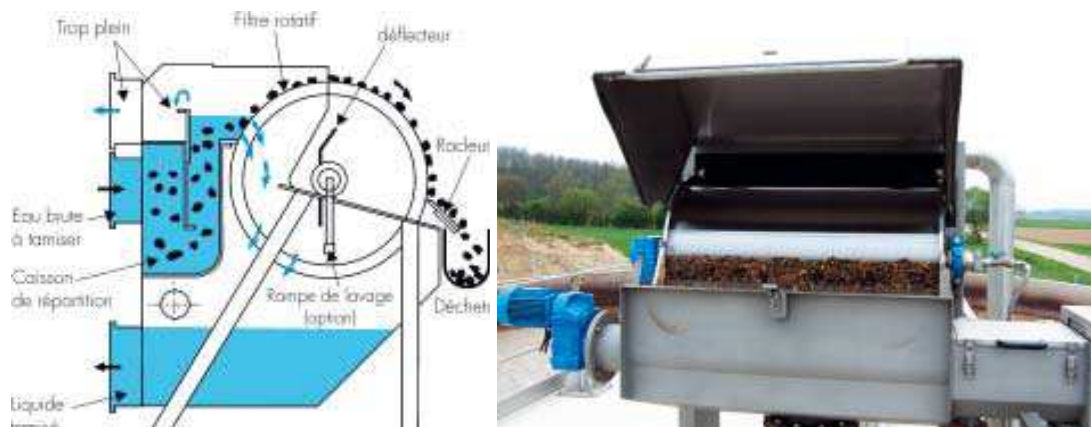
Figure 25 : Tamis rotatif à alimentation externe
