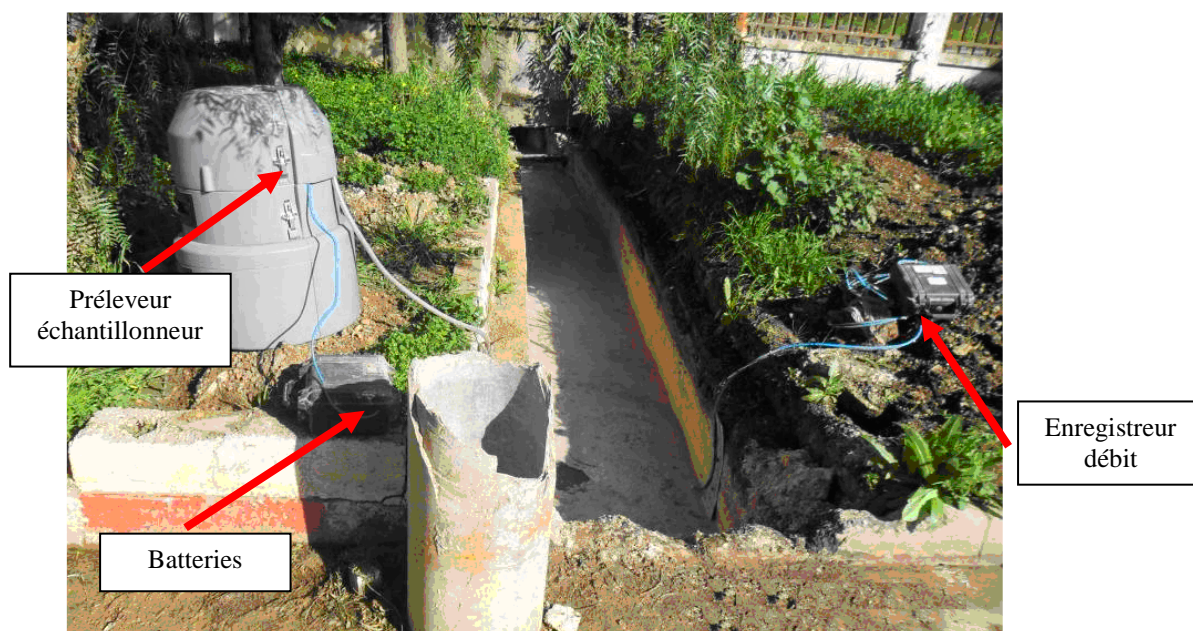
Figure 23 : Matériels de mesure de débit et d'échantillonnage installés au niveau de SOCOV
