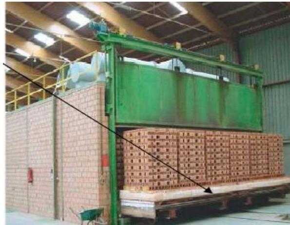
**Fig. 1.2: Wagonnet chargé de produit cru à l'entrée d'un four tunnel.**
