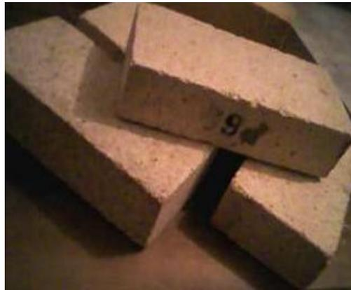
**Fig. 2.1. Briques réfractaires silico-alumineuses BSAA**
