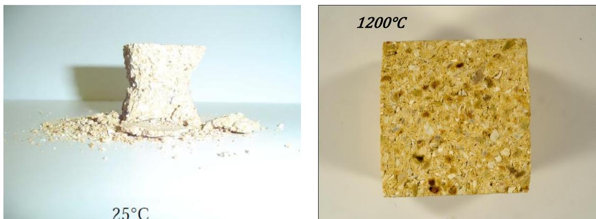
Figure 2.29. Aspect des éprouvettes après essais de compression après rupture
