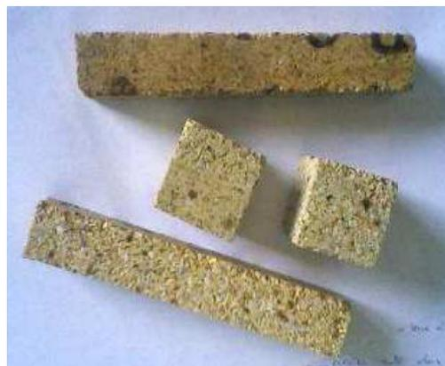
**Fig.2.2. Eprouvettes découpées dans les briques BSAA, destinées aux essais mécaniques de compression uniaxiale et de flexion trois points.**
