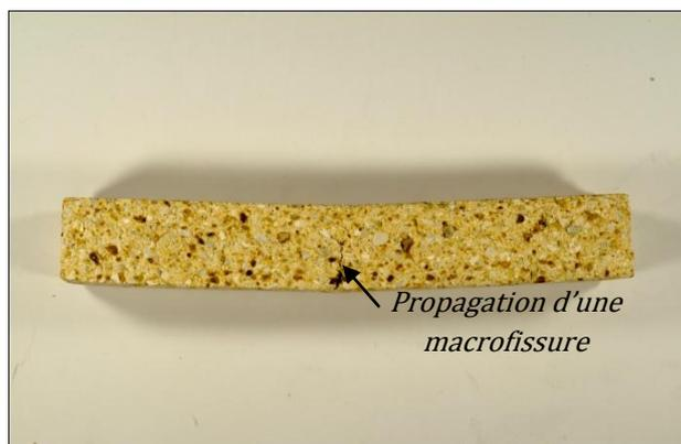
**Fig.2.30. Eprouvette testée en flexion 3points à 1200°C**
