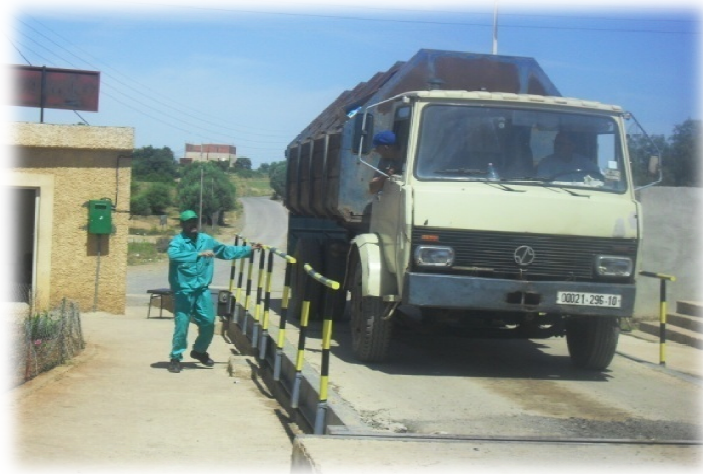
Figure28: Contrôle d'admission des déchets au niveaux de CET.
