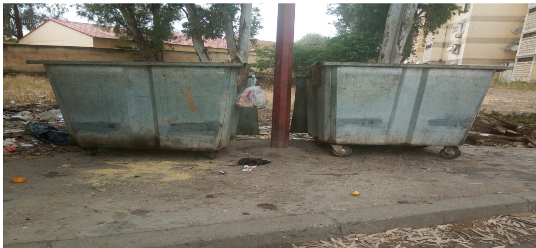
Figure 07 : bacs roulants métalliques 770 litres(original).
