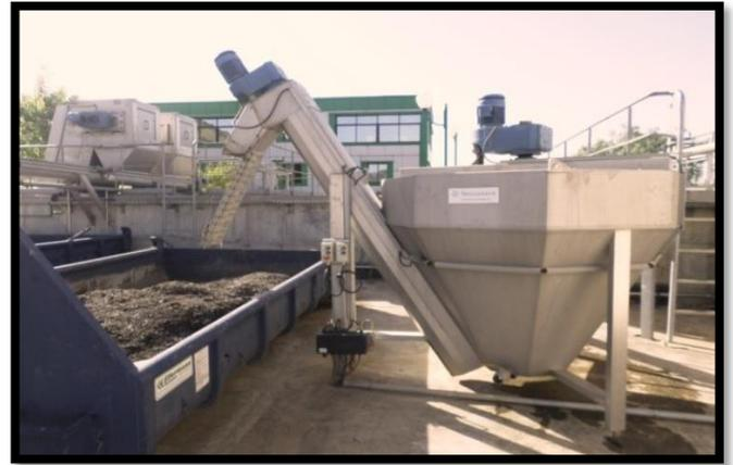
**Figure n°6 : Laveuse de sable**
