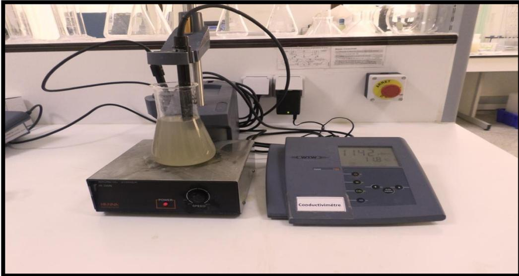
Figure n°19 : Conductimètre.
