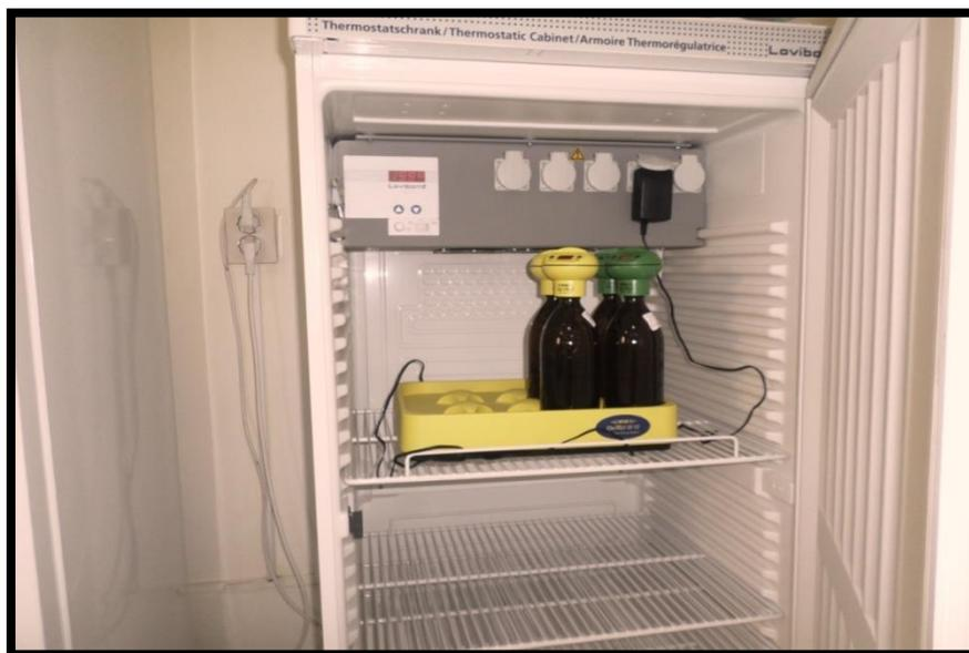
Figure n° 31 : Incubateur DBO + Oxitop.
