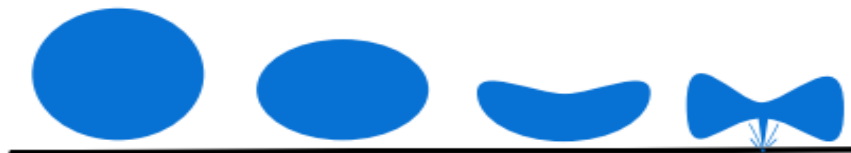
Figure 06: Evolution d'une bulle de cavitation à proximité d'une surface solide, adapté de (Pétrier et al. , 2008) .
