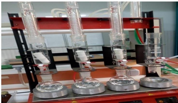
Figure 13 : Appareil de Soxhlet.
