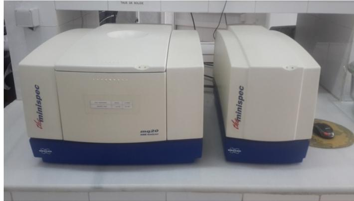
**Figure 05** : Spectromètre de résonance magnétique nucléaire (RMN).
