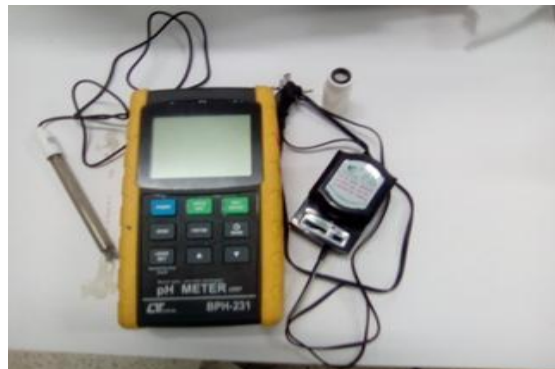
Figure 13 : PH METER (de type BPH-231).
