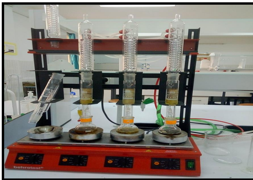
Figure 07: l'extraction des HAP a l'aide de Soxhlet
