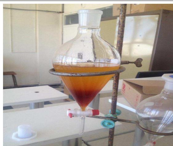
**Figure 24** : Décantation de biodiesel dans une ampoule à décanter
