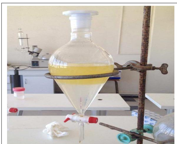
**Figure 25** : Remontée du biodiesel après le lavage du produit.
