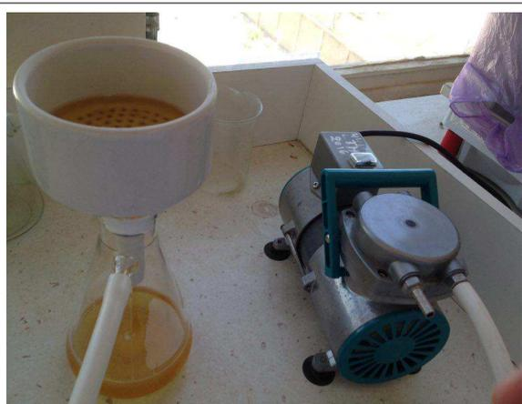
**Figure 22** : Filtration sous vide de l'huile de friture usagée.
