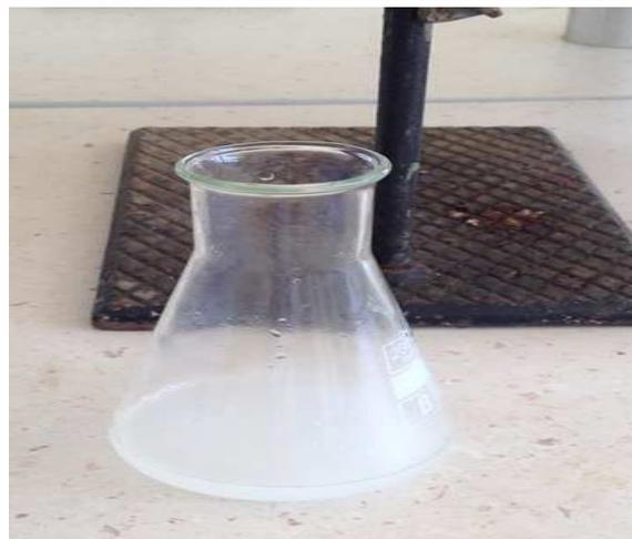
**Figure 33** : Indice de peroxyde, essai à blanc après le titrage
