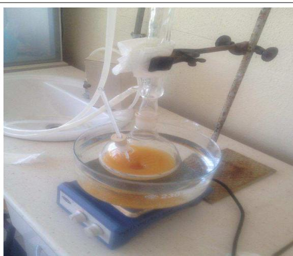
**Figure 23** : Montage de la réaction de transestérification
