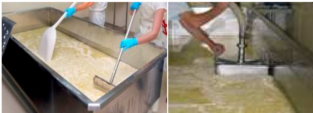
Figure 15 : Brassage et délactosage de caillé.
