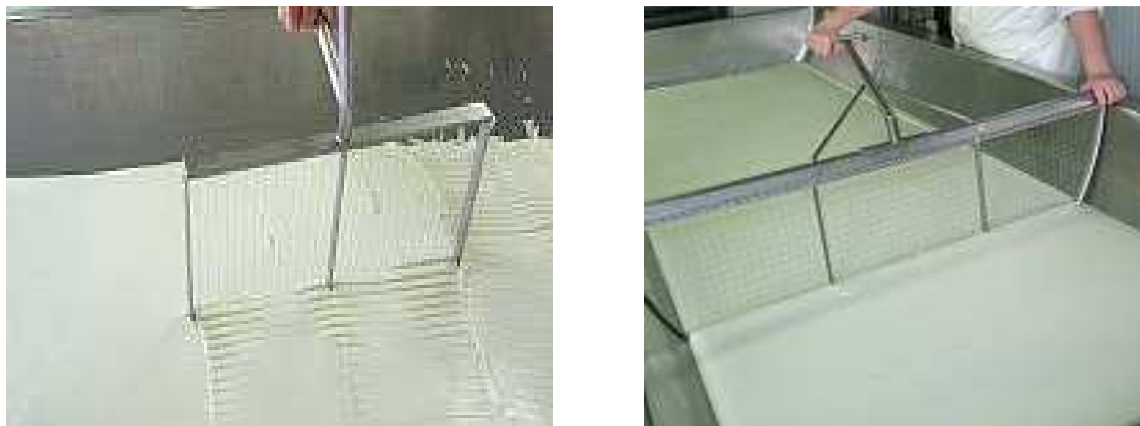
Figure 14: Découpage de caillé avec des tranches-caillé.
