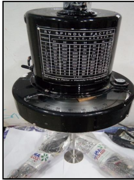
Figure II.5 : Viscosimètre Brookfield (LABOMAT).
