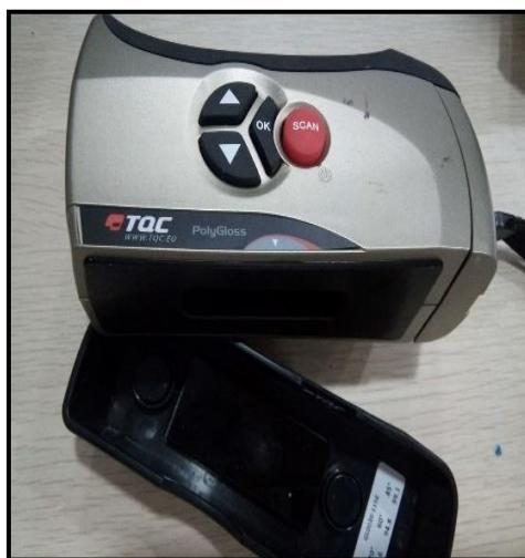
Figure II.7 : Brillance-mètre (TQC polygloss).
