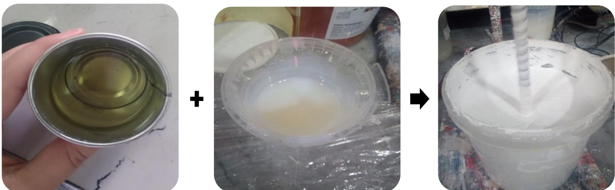
Figure II.11 : Finition par le solvant et le liant.
