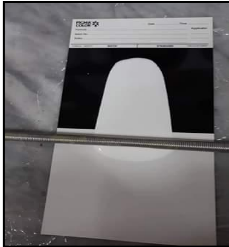
Figure II.6 : Applicateur du film de peinture.
