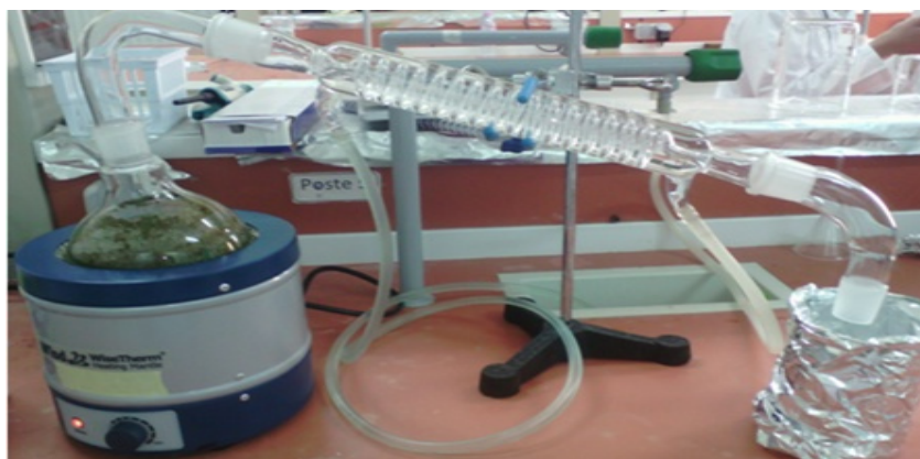
Figure n° 10 : Montage d'hydro distillation employé pour l'extraction des huiles essentielles (Originale)
