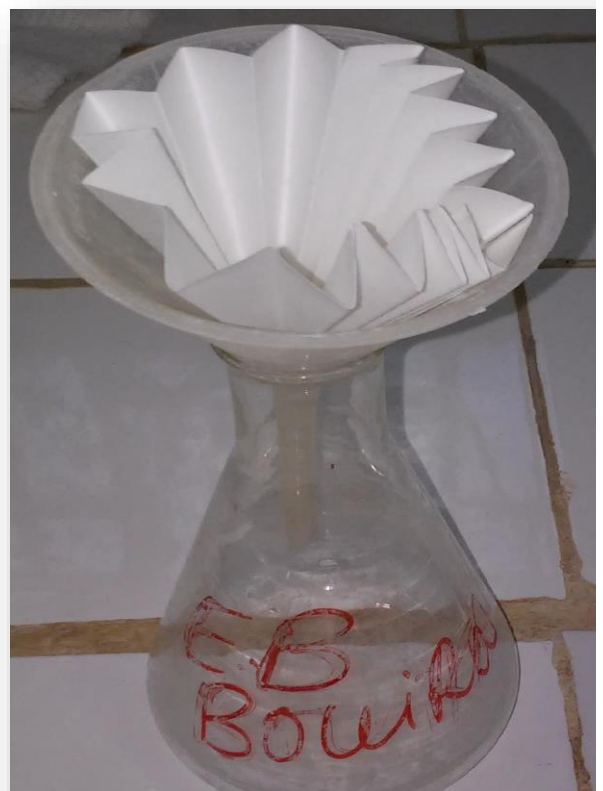
Figure 17 : La filtration d'eau brute.
