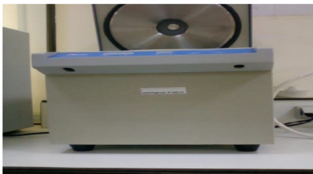
Figure 20 : Centrifugeuse (source : auteur)
