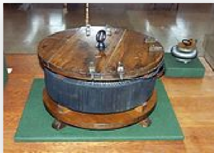
Figure1.2. Transformateur cuirassé, conçu par Uppenborn suivant les brevets de 1885 des ingénieurs Ganz.
