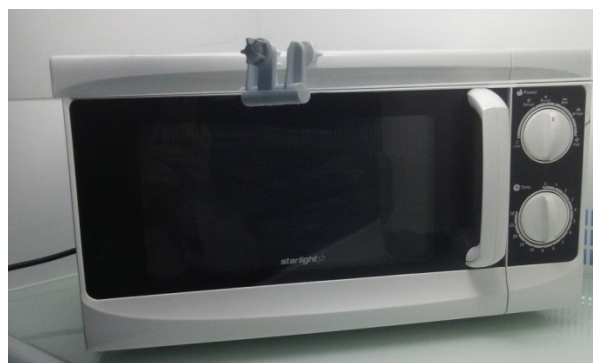
Figure 5. Le four micro-ondes domestique « Starlight » utilisé pour le traitement des boues d'épuration.
