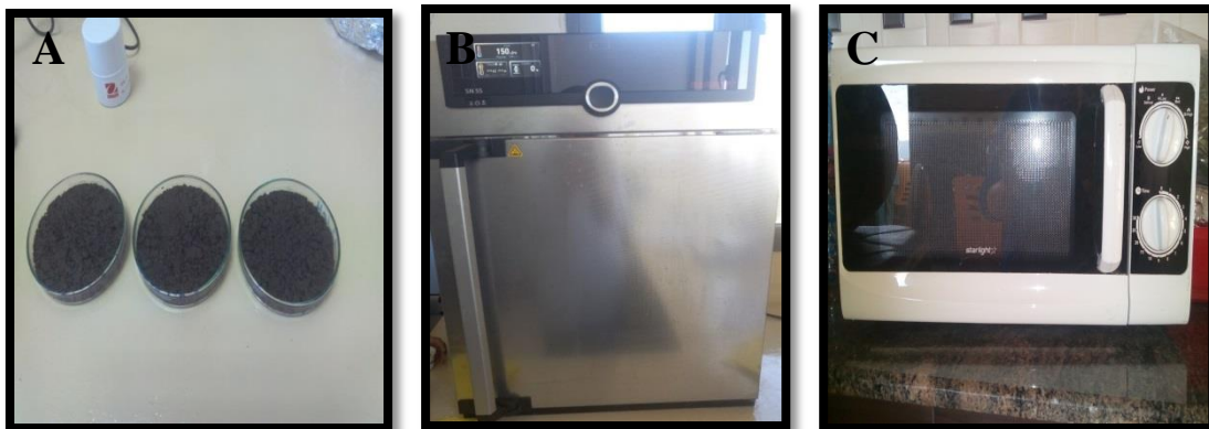
Figure 5 : l'échantillon de boue avant séchage (A), séchage par étuve (B) et séchage par micro-onde(C).
