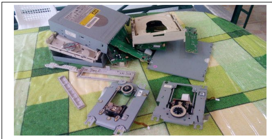
Figure. IV.6: Système de déplacement linéaire récupéré sur un lecteur de DVD.
