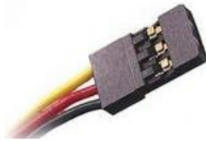
Figure II.22 : Fils de connexion d'un servomoteur [22]
