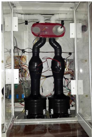
Figure III. 19: Mécanisme de la circulation d'air
