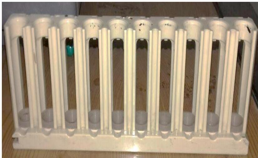
**Figure 7 :** Portoir à échantillons de l'analyseur D-10
