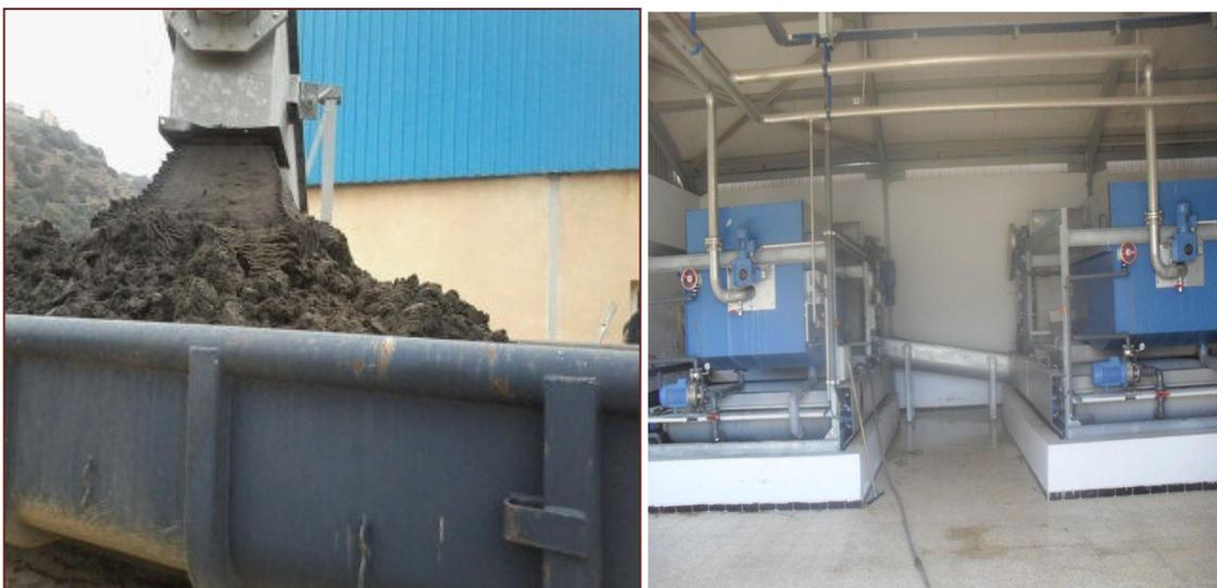
**Figure 9:** photos de la déshydrations mécanique des boues.
