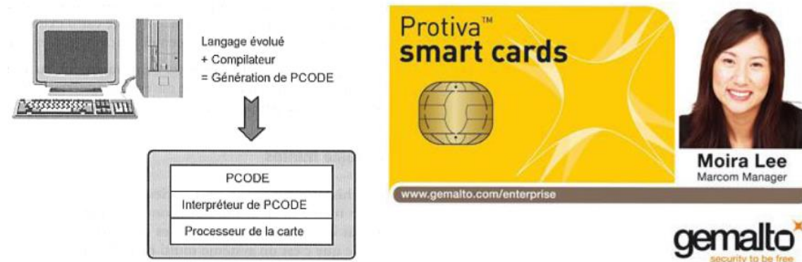
Fig. 2. 10: Principe des cartes à puce dites "à OS ouvert" (exp. Protiva smart Card) [10].
