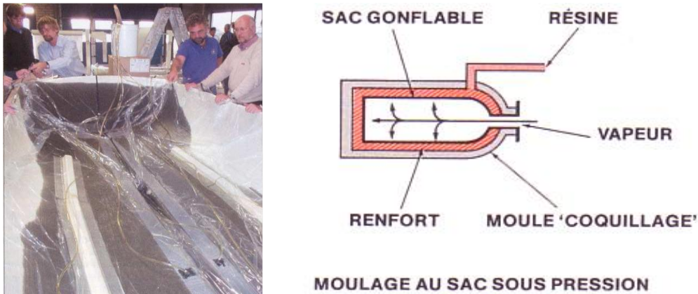
Fig.1.15. Moulage au sac sous vide.
