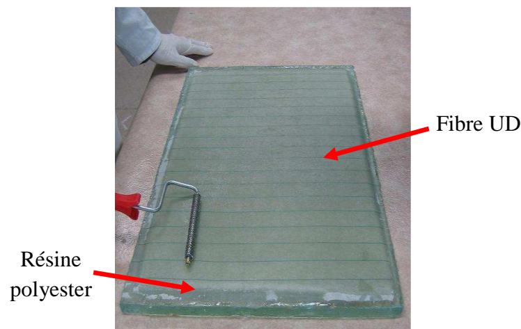
Fig.1.2. Matériau composite UD [2].
