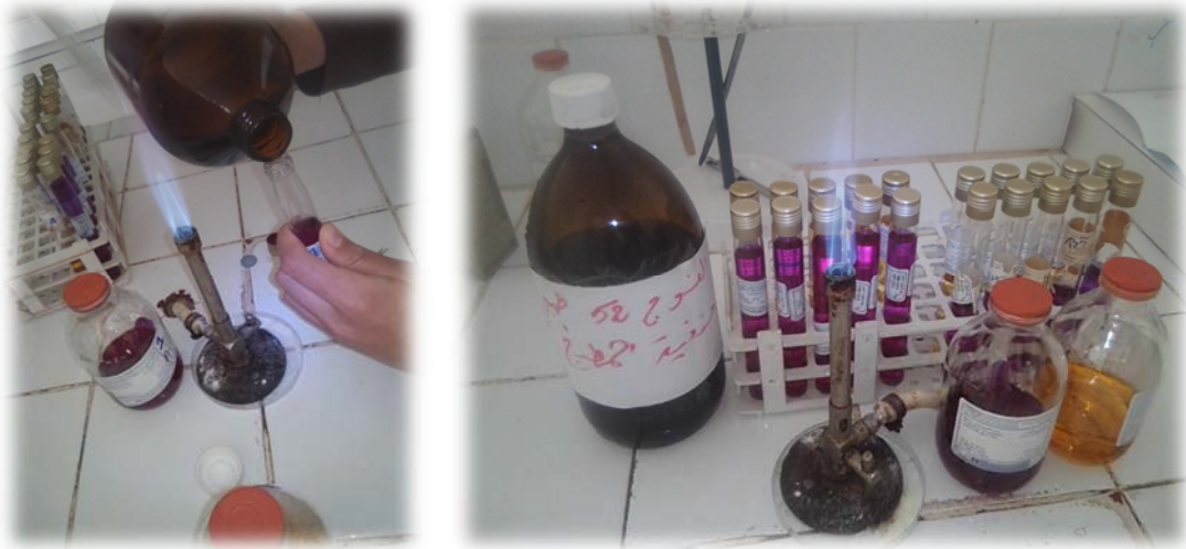
Figure : méthode de recherche des coliformes (totaux et fécaux) et des streptocoques fécaux dans l'eau de procédé.
