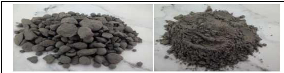
**Figure. II.1:** *Le clinker avant et après broyage .*
