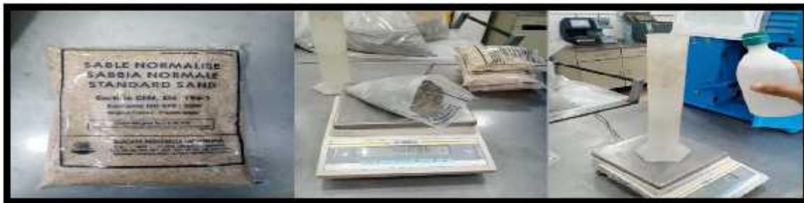
**Figure.II.9:** *Sable normalisé, pesée d'eau et de ciment.*
