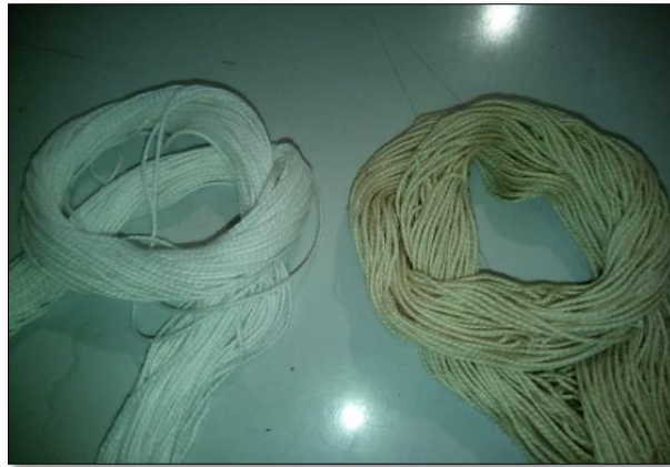
Figure 3.9 : Fil en coton avant et après blanchiment.
