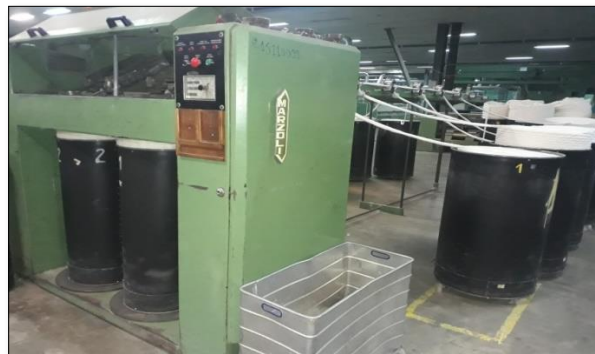
Figure 2.3 : Ligne de doublage et étirage.
