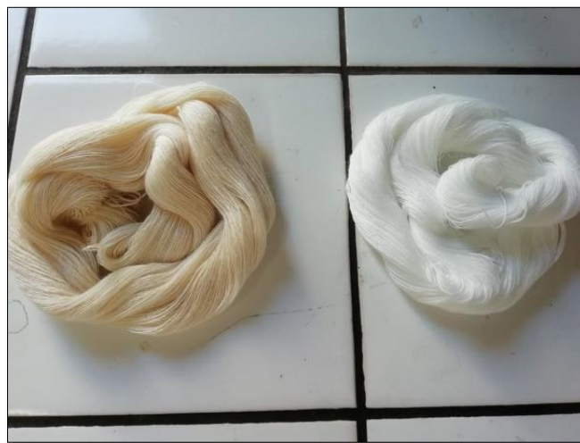
Figure 3.8: Fil en polyester avant et après blanchiment.
