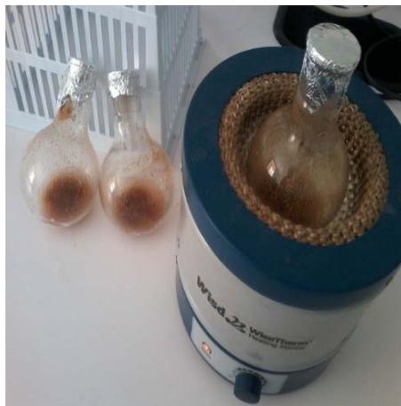
**Figure07 :** Photographie représente la détermination du Substances extractibles par l'eau distillée.
