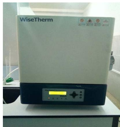
**Figure 02** : four du WiseTherm
