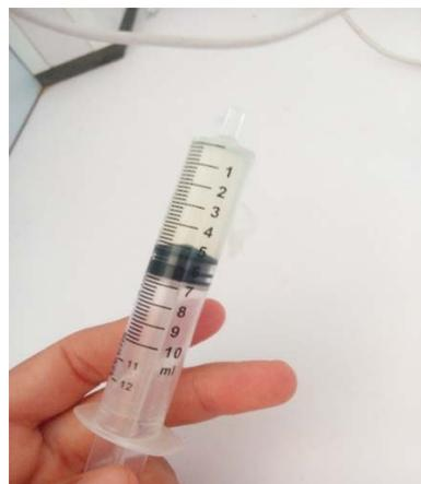
**Figure 14 :** Photographie représente la détermination de volume de sérum présent sur la surface du pot de yaourt
