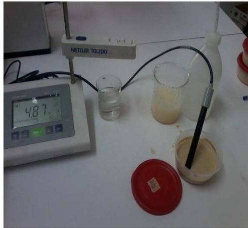
**Figure 10 :** Photographie de mesure du pH de yaourt nature et yaourt fabriqué à base de la poudre de *Crataegus monogyna* à l'aide de pH-mètre
