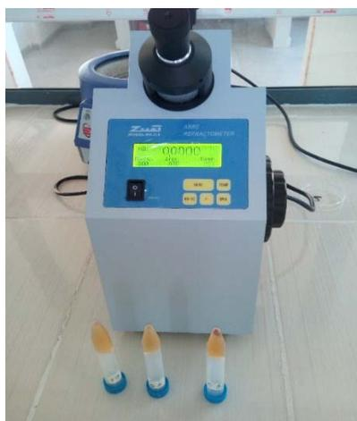
**Figure 05:** Réfractomètre (ZUZI MODEL NO .315)
