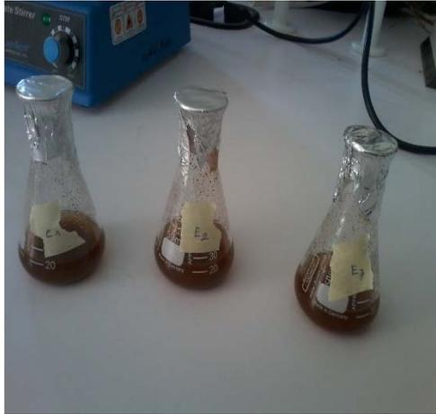
**Figure 06 :** Photographie représente la détermination du Substances extractibles par l'éthanol
