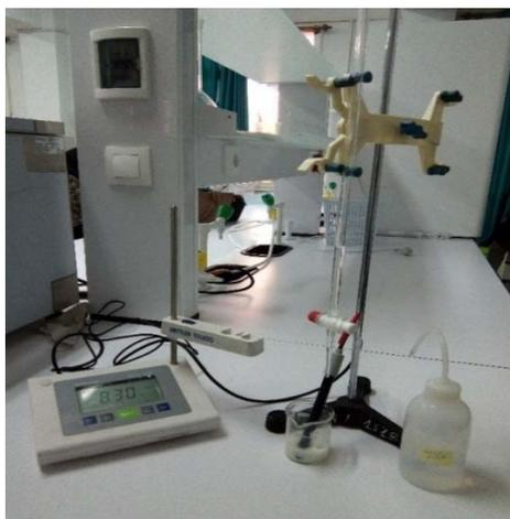
**Figure 11 :** Photographie représente la détermination de l'acidité titrable de yaourt.
