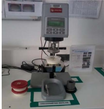
**Figure 15** : Détermination de la viscosité par un viscosimètre reolab de marque Anton Paar RheolabOC
