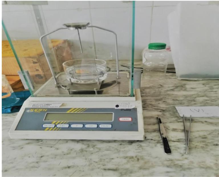
Figure III.11 : Détermination de la masse volumique.
