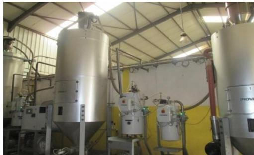
**Figure III.6:** Les sécheurs (silos).
