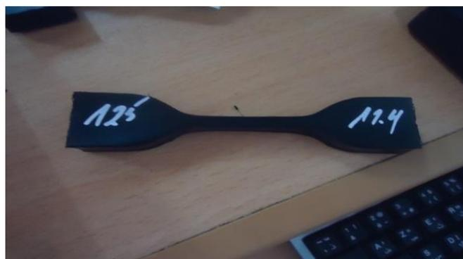
**Figure III.8:** Exemple d'éprouvette.
