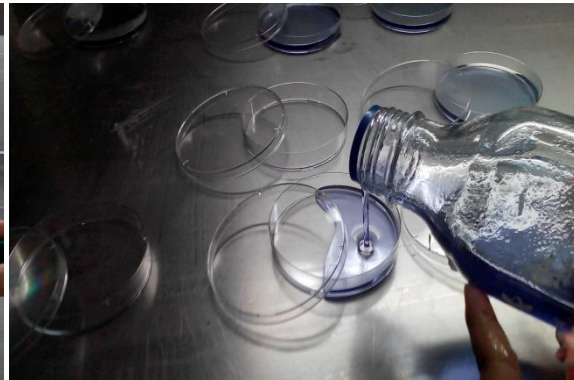
Figure 15: Répartition de milieu gélosé dans des boîtes pétries.
