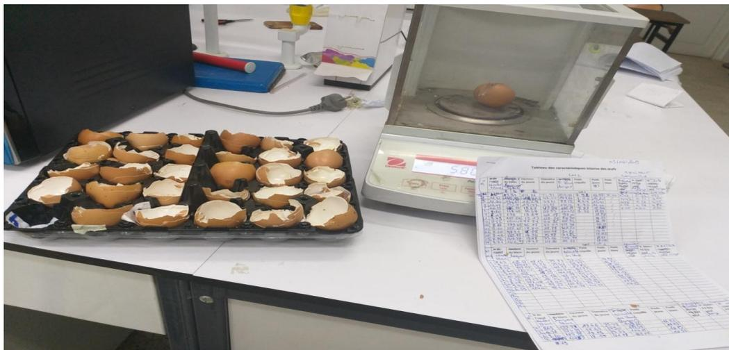
Figure 28 : Pesée de la coquille à l'aide d'une balance de haute précision
