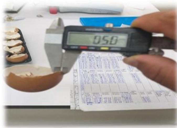
**Figure 29** : Mesure de l'épaisseur de la coquille.
