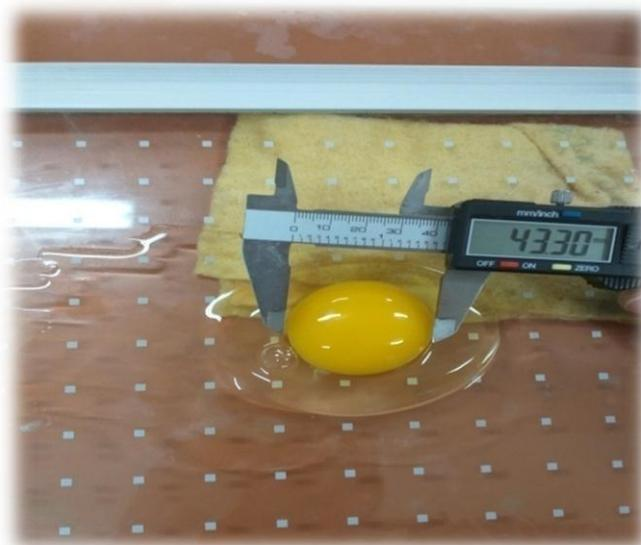
**Figure 31** : Mesure de largeur du vitellus à l'aide de pied à coulisse
