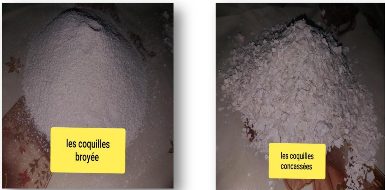
**Figure 21 :** la forme finale de présentation des coquille (broyée et concassée ).
