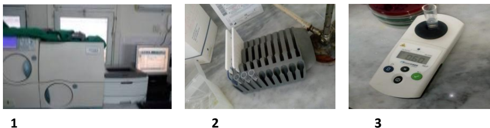
Figure 10: Présentation de Vitek2. (1) Vitek 2, (2) Cassette avec portoir, (3) Densimètre.
