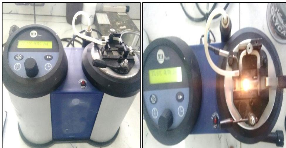
**Figure II.8:** Appareil de mesure du point d’éclair (SETA Flash)
