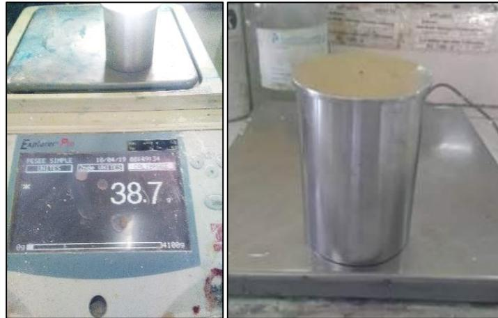
**Figure II.2 :** Balance + Pycnomètre pour mesurer la densité
